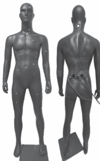
Hình 7. Mô hình manikin tỏa nhiệt mặt trước và mặt sau
