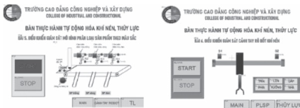
Hình 9. Giao diện HMI điều khiển, giám sát các mô hình
