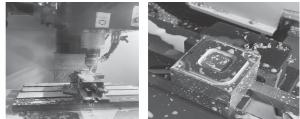
Hình 9. Gia công sản phẩm trên máy phay Xmill M640
