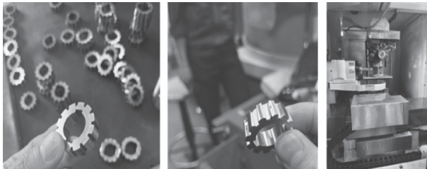
Hình 7. Ảnh minh họa quá trình chế tạo dao chuốt
