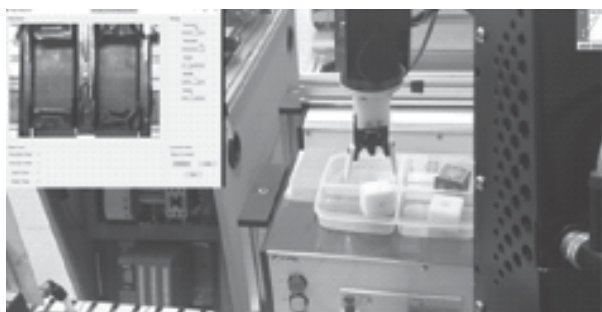
Hình 20. Robot thả phôi nhựa không lỗ vào khay
