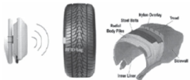
Hình 2.6. Công nghệ RFID trên lốp
