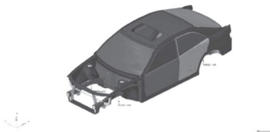
Hình 3. Mô hình rung động khi có kích thích của động cơ và mặt đường
