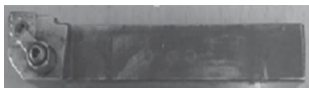
(b) Thân dao có gắn mảnh dao
