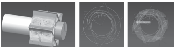
Hình 8. Hình ảnh 6 vùng gia công phay thô trên máy Mill-Turn khi lập trình trên phiên bản NX11
