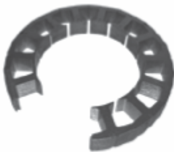
Hình 11. Nguyên công uốn sơ bộ trên khuôn uốn trước khi hàn thành lõi động cơ điện
