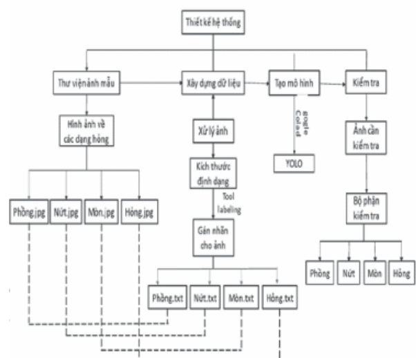
Hình 3.1. Sơ đồ hệ thống nhận dạng lỗi hỏng trên lốp xe ô tô
