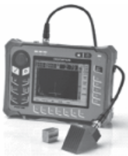
Hình 5. Máy siêu âm OLYPULSEPOCH 600
