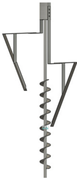
Hình 1. Khâu vít tải và khâu đảo bột bên trong máy rót bột tự động.
