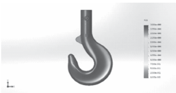
Hình 6. Hệ số an toàn của móc đơn
