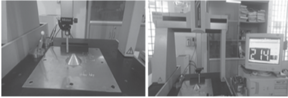
Hình 4. Đo tọa độ chi tiết bằng máy đo tọa độ
