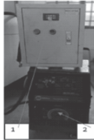
Hình 2. Thiết bị cung cấp dòng điện một chiều: 1. Đồng hồ hiển thị; 2. Nút điều chỉnh.
