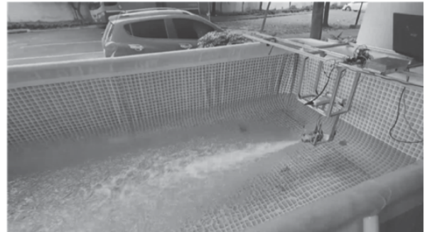
Hình 3. Thực nghiệm đo lực đẩy của hệ thống waterjet
