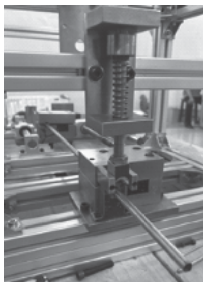
Hình 5. Module đẩy ống được lắp lên thân máy
