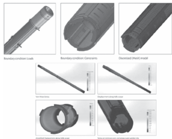
Hình 3. Quá trình phân tích mô phỏng cần khoan từ Công ty SIP&T Foundation Drilling Tools
