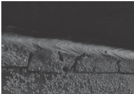
Hình 3. Mẫu sau hàn được cắt để đo
